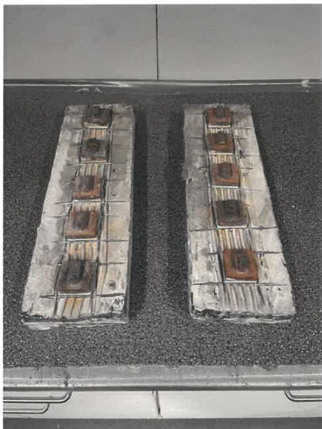
Bild 6: Probekörper nach Wasserlagerung mit aufgeklebten Zugankern
