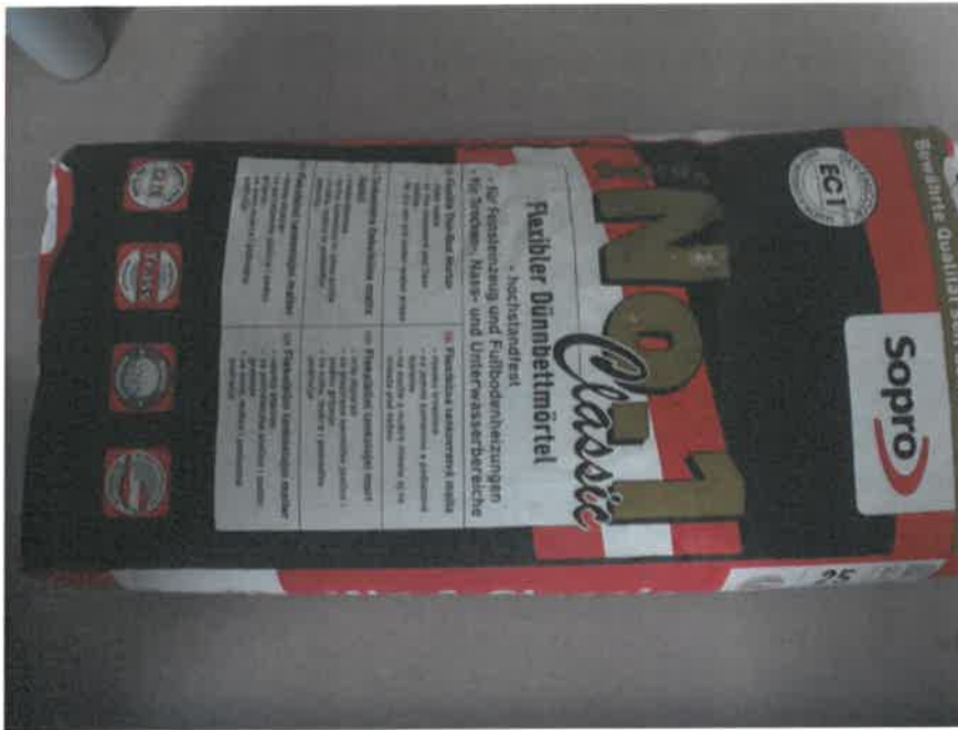
Bild 3: Angeliefertes Prüfgut, zementhaltiger Mörtel „Sopro's No.1 Classic“
