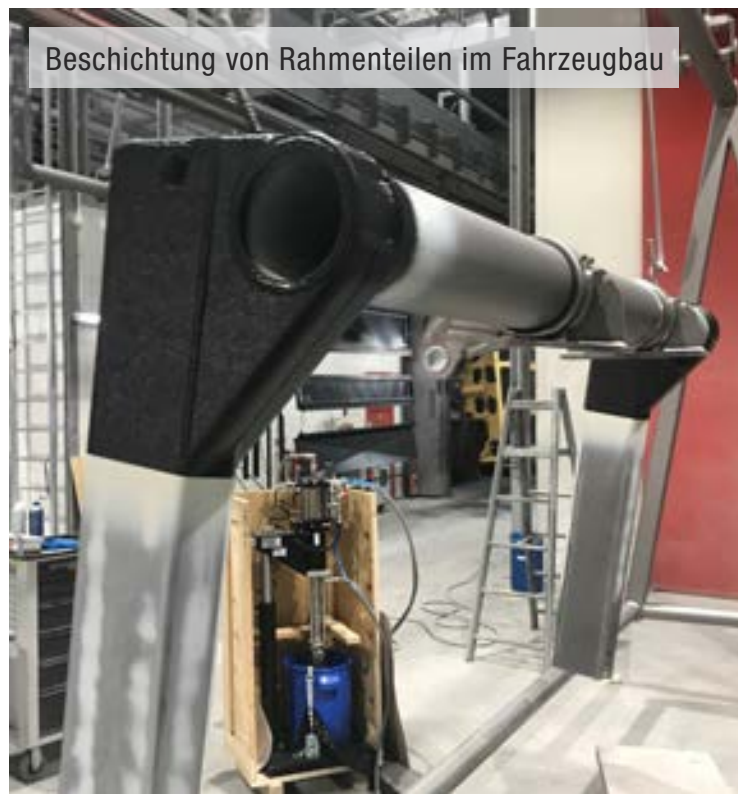
Antidröhnschutz (z.B. bei Müllwagen)
