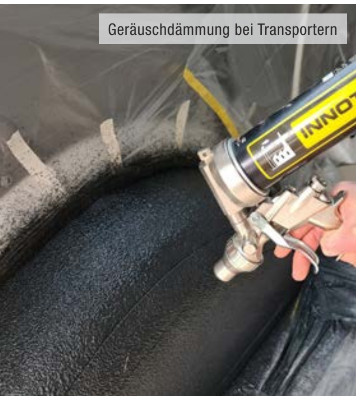
Antidröhnschutz (z.B. bei Müllwagen)
