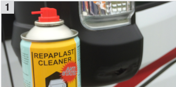
1 Den Untergrund mit Repaplast Cleaner Antistatic (Kunststoff-Reiniger) und Multi Wipes Tuch (Universaltuch) reinigen (ca. 5 Min. ablüften lassen).
