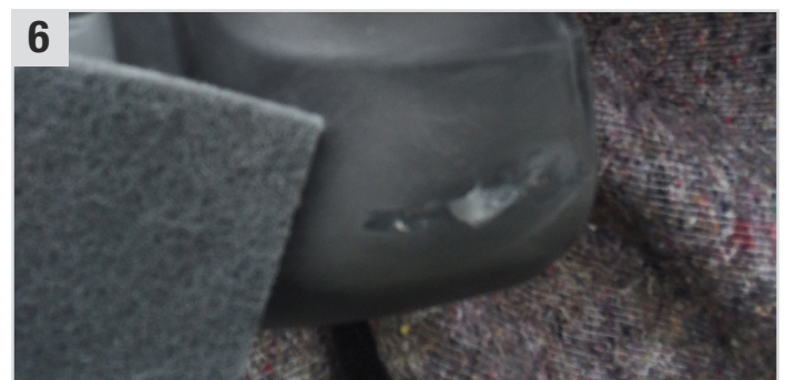
6 Ausgehärteten Quick Bond mit K120, K220, K320 glatt schleifen und Übergang mit Shine P 600 (Schleifvlies) aufrauen.
