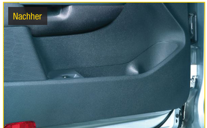
4 Anschließend die entsprechende Repaplast Colour Finish Better Care (Kunststofflack) Farbe aus ca. 25 cm Entfernung in zwei dünnen Schichten auftragen - dazwischen 5 bis 10 Minuten ablüften lassen - Fertig!
