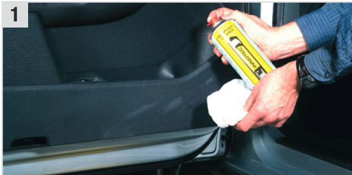
1 Die Kunststoffteile mit Repaplast Cleaner Antistatic (Kunststoff-Reiniger) und Multi Wipes Tuch (Universaltuch) reinigen.
