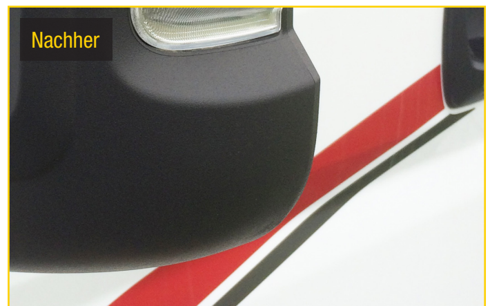
10 Anschließend die entsprechende Repaplast Colour Finish Better Care (Kunststofflack) Farbe aus ca. 25 cm Entfernung in zwei dünnen Schichten auftragen - dazwischen ca 5 bis 10 Min. ablüften lassen - Fertig!
