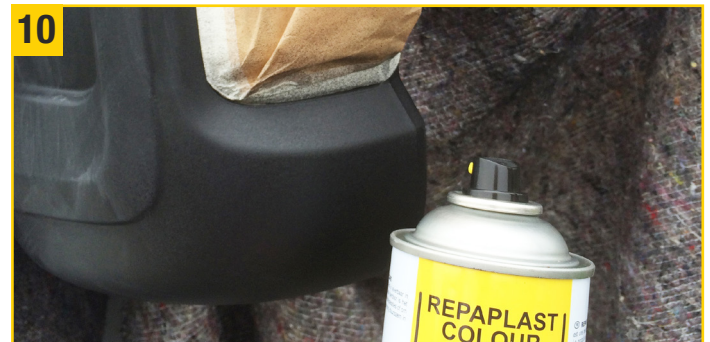
10 Anschließend die entsprechende Repaplast Colour Finish Better Care (Kunststofflack) Farbe aus ca. 25 cm Entfernung in zwei dünnen Schichten auftragen - dazwischen ca 5 bis 10 Min. ablüften lassen - Fertig!
