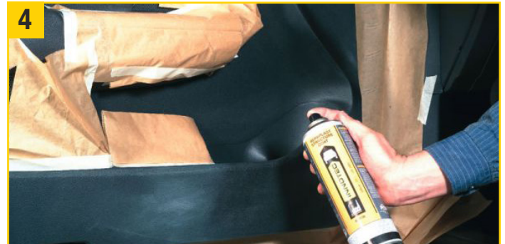
4 Anschließend die entsprechende Repaplast Colour Finish Better Care (Kunststofflack) Farbe aus ca. 25 cm Entfernung in zwei dünnen Schichten auftragen - dazwischen 5 bis 10 Minuten ablüften lassen - Fertig!
