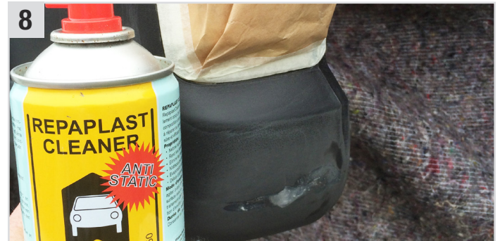
8 Die zu behandelnde Stelle nochmals mit Repaplast Cleaner Antistatic (Kunststoff-Reiniger) und Multi Wipes Tuch (Universaltuch) reinigen (ca. 5 Min. ablüften lassen).
