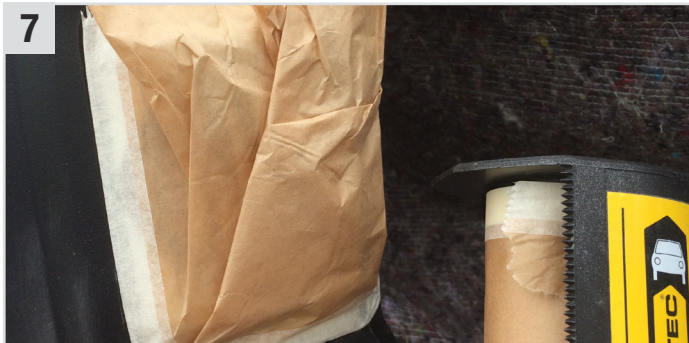
7 Angrenzende Teile mit Masking Paper Dispenser (Abdeckpapier) abdecken.
