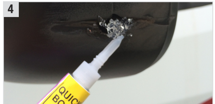
4 Die Beschädigung mit Quick Bond (Sekundenkleber) auffüllen und...
