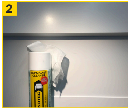
2 Untergrund mit Repaplast Cleaner Antistatic und Multi Wipes gut reinigen (ca. 5 Min. ablüften lassen).
