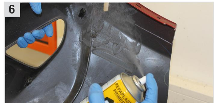
**6** Dünne Schicht **Repaplast Primer New Formula** (Kunststoff-Haftvermittler) auf Vorder- und Rückseite anbringen (ca. 10 Min. ablüften lassen).
