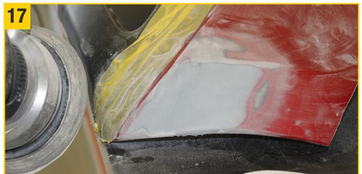
**Repaplast Finish** (2K-Kunststoffkitt) mit **Royalcut** (Runde Klettdisketten) K120, K220 und K320 schleifen - weitere Schritte laut Lackhersteller. **Fertig!**
