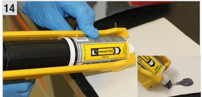
**Repaplast Finish** (2K-Kunststoffkitt) mithilfe der **Easy Grip Gun** (Kartuschenpistole) herausgepresst. Beide Komponenten müssen rauslaufen.
