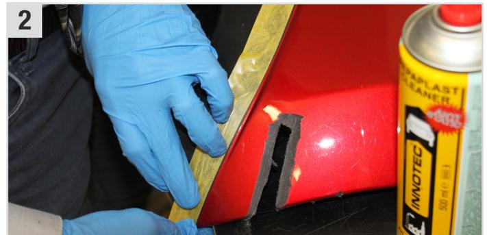
**2** Anschließend die zu schützenden Stellen mit **SunCore Pro** (Abdeckband) abkleben.
