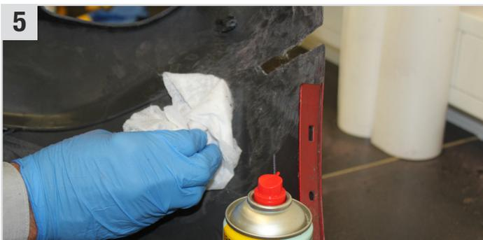
**5** Nochmals Außenseite und Innenseite mit **Repaplast Cleaner Antistatic** (Kunststoff-Reiniger) und **Multi Wipes Tuch** (Universaltuch) gut reinigen und trockenwischen (ca. 5 Min. ablüften lassen).
