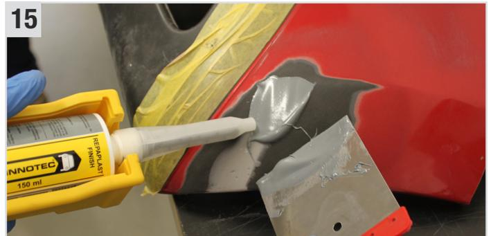
... mit der **Repaplast Finish Nozzle** (2K-Mischdüsen für Repaplast Finish) direkt auftragen .
