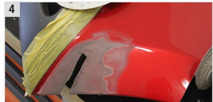
**4** Auf der Außenseite des Stoßfängers den Riss großflächig mit **Royalcut** (Runde Klettdisketten) K120 anschleifen.
