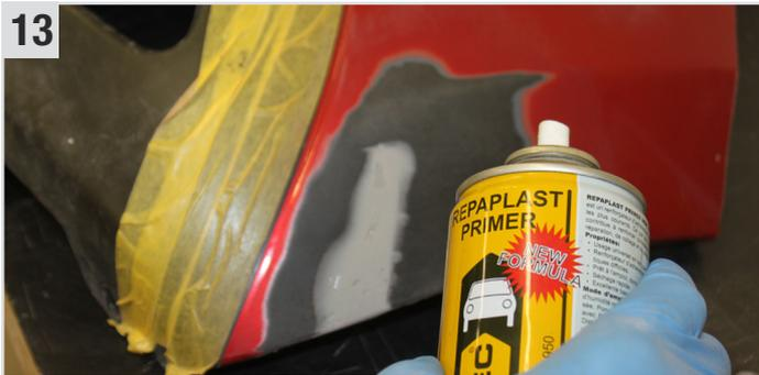
Eine dünne Schicht **Repaplast Primer New Formula** (Kunststoff-Haftvermittler) auftragen und ca. 10 Min. ablüften lassen.
