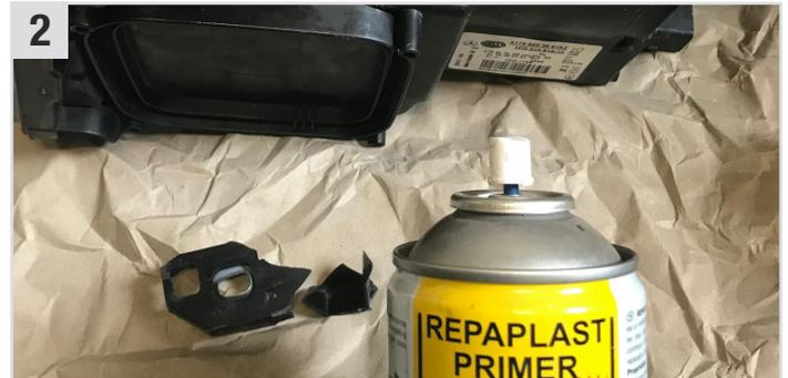
Eine dünne Schicht **Repaplast Primer New Formula** (Kunststoff-Haftvermittler) auf die abgebrochenen Halterungen und die Reparaturstelle auftragen und ca. 10 Min. ablüften lassen.
