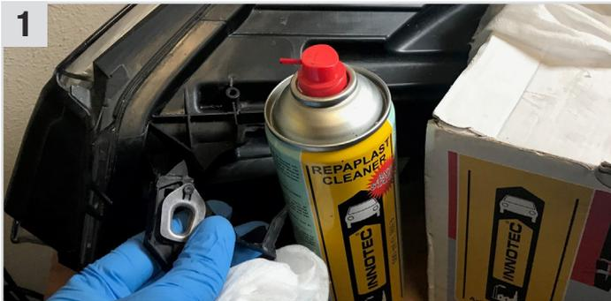
Die Schadstelle und die abgebrochene Halterung mit **Repaplast Cleaner Antistatic** (Kunststoff-Reiniger) und **Multi Wipes Tuch** (Universaltuch) gut reinigen und trockenwischen (ca. 5 Min. ablüften lassen).
