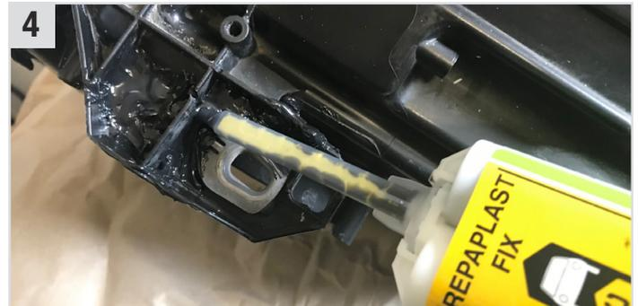
**Repaplast Fix** (2K-PU-Klebstoff) ist nach 35 Sekunden griff trocken und nach 1 Stunde durchgehärtet.
