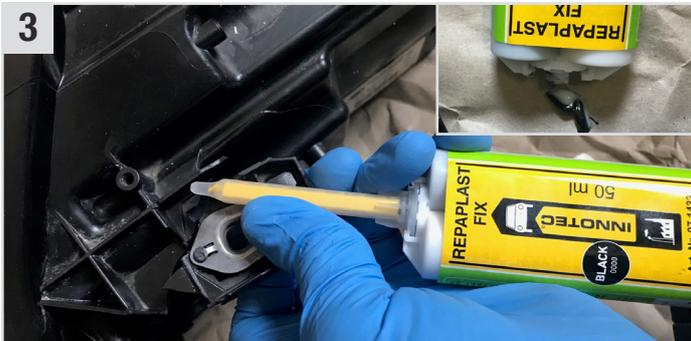
Vor dem Aufsetzen der **Mixer Nozzle Gelb** (2K-Mischdüsen) kontrollieren, dass beide Komponenten von **Repaplast Fix** (2K-PU-Klebstoff) rauslaufen und anschließend die Verklebung der Halterung vornehmen.
