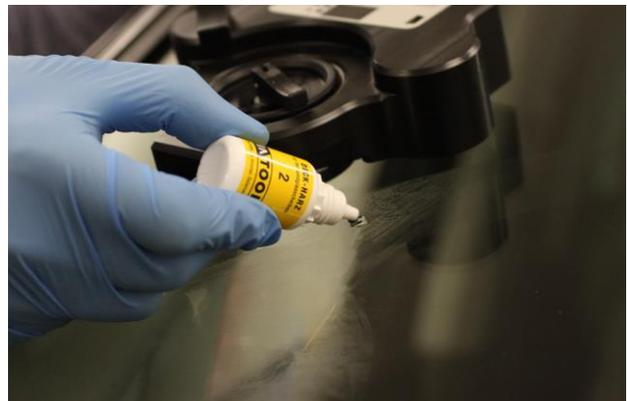
Steinschlagreparatur in 3...2...1 mit dem Windschutzscheiben-Reparatursatz von INTOOL.
