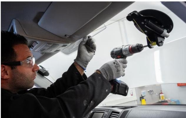
Mit dem 1-Person-Austrennsystem gelingt das Scheibenaustrennen einfach & effizient.
