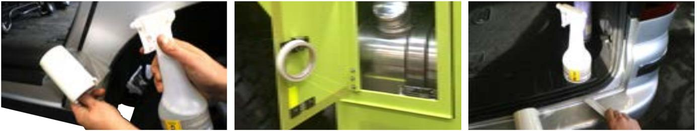
Die Innotec Steinschlagschutz-Folien wurden speziell entwickelt, um nach Reparaturarbeiten an Karosserieteilen die notwendigen Steinschlagschutz-Folien zu ergänzen.
