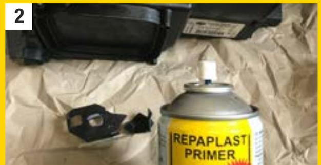
2 Eine dünne Schicht Repaplast Primer New Formula (Kunststoff-Haftvermittler) auf die abgebrochenen Halterungen und die Reparaturstelle auftragen und ca. 10 Min. ablüften lassen.
