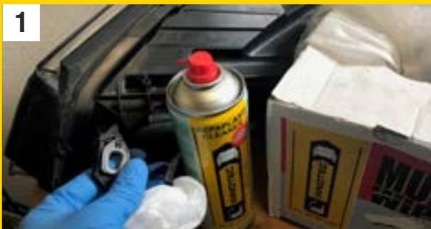
1 Die Schadstelle und die abgebrochene Halterung mit Repaplast Cleaner Antistatic (Kunststoff-Reiniger) und Multi Wipes Tuch (Universaltuch) gut reinigen und trockenwischen (ca. 5 Min. ablüften lassen).
