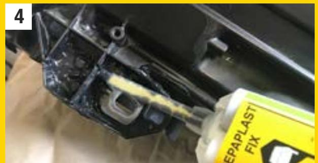
4 Repaplast Fix (2K-PU-Klebstoff) ist nach 35 Sekunden grifftrocken und nach 1 Stunde durchgehärtet.
