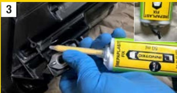
3 Vor dem Aufsetzen der Mixer Nozzle Gelb (2K-Mischdüsen) kontrollieren, dass beide Komponenten von Repaplast Fix (2K-PU-Klebstoff) rauslaufen und anschließend die Verklebung der Halterung vornehmen.
