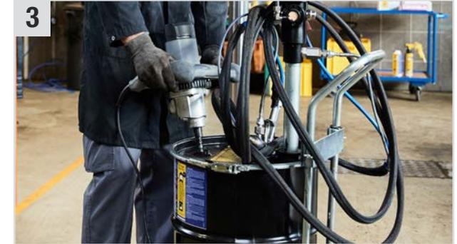
**3** Bei Verwendung des 60 Liter Fasses muss der Inhalt mit Hilfe unseres **Rührwerks** aufgerührt werden. Die 1 Liter Normdose gut aufschütteln.
