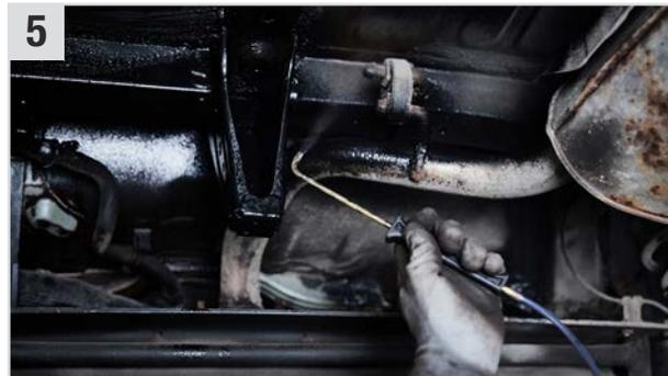
**5** Eine geschlossene Schicht (200 $\mu$  - 250 $\mu$  nass) **Hi-Temp Wax Pro** mit entspr. Verarbeitungswerkzeug (Winkeldüse) auf den Unterboden auftragen (kein Rostumwandler / Grundierung notwendig).
