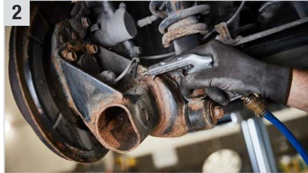
**2** Groben und losen Rost vom Unterboden mit Druckluft und Drahtbürste entfernen.
