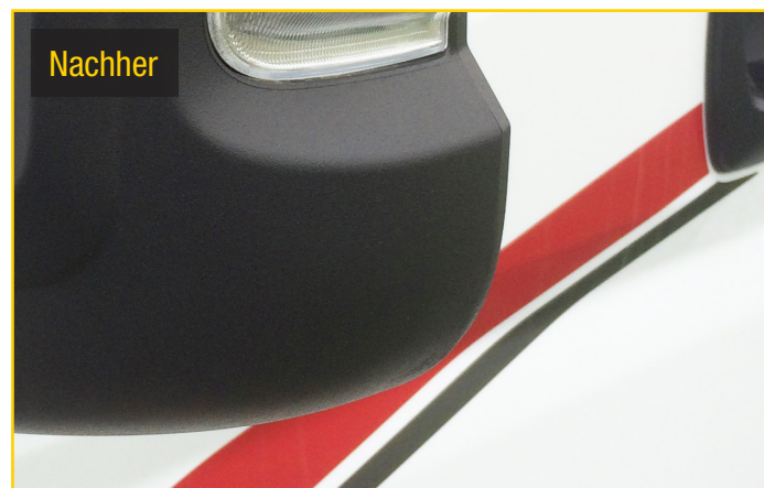
Anschließend die entsprechende Repaplast Colour Finish Better Care (Kunststofflack) Farbe aus ca. 25 cm Entfernung in zwei dünnen Schichten auftragen - dazwischen ca 5 bis 10 Min. ablüften lassen - Fertig!
