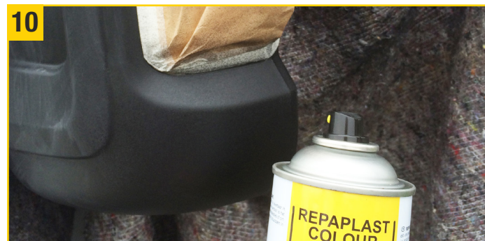
Anschließend die entsprechende Repaplast Colour Finish Better Care (Kunststofflack) Farbe aus ca. 25 cm Entfernung in zwei dünnen Schichten auftragen - dazwischen ca 5 bis 10 Min. ablüften lassen - Fertig!
