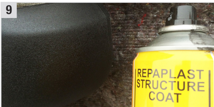
Repaplast Structure Coat NF (Strukturspray) bis zur gewünschten Struktur (eventuell in mehreren Schichten) auftragen (ca. 5 Min. ablüften lassen).
