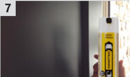
2 deckende Schichten **Body Finish Graphitblau (7021)** (Kunststofflack) auftragen (ca. 10 Min. trocknen lassen).
