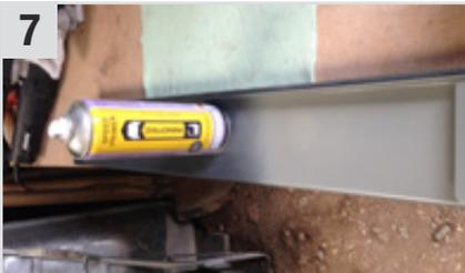
**Speed Primer Anthrazit (5020)** (Grundierungs- und Füllerspray) in einer deckenden Schicht auftragen (ca. 20 Min. trocknen lassen).
