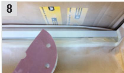
Mit **Royalcut** (Schleifpapier) - K 800 oder **Shine P 600** (Schleifvlies) abziehen und mit **Multi Wipes Box** (Universaltuch) feinen Schleifstaub entfernen.
