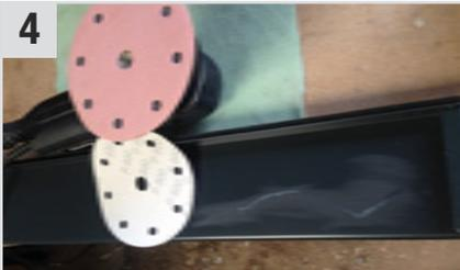
Nochmals mit **Schleifpapier - K 400 / K 500** Quick Bond (Sekundenkleber) plan (eben) schleifen und mit **K 600** nachschleifen.
