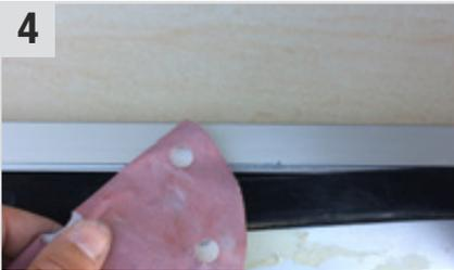
Nochmals mit **Schleifpapier** - K 400 / K 500 **Quick Bond** (Sekundenkleber) plan (eben) schleifen und mit **K 600** nachschleifen. Dann mit **Shine P 600** (Schleifvlies) aufrauen.
