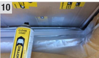
**Clear Coat** (Kristallklarer Klarlack) mit einem Sprühabstand von 25 bis 30 cm erst eine dünne Schicht auftragen und 5 Min. ablüften lassen, danach zwei fließende Kreuzschichten auftragen.
