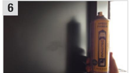
**Speed Primer Anthrazit (5020)** (Grundierungs- und Füllerspray) in einer deckenden Schicht auftragen (ca. 20 Min. trocknen lassen). Mit **Shine P 600** (Schleifvlies) abziehen und mit **Multi Wipes Box** (Universaltuch) den feinen Schleifstaub entfernen.
