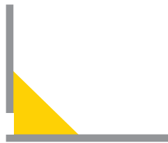
Richtig: Gerade Dichtfuge
