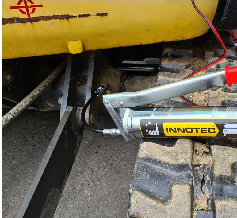
Innogrease STF 300 ist ein besonders hochwertiges, vielseitig einsetzbares Hochleistungsfett (NLGI-2) auf Lithiumkomplex-Basis mit PTFE-freier TRIBITEC-Technologie. Es sorgt auch bei hohen Druck- und Temperaturbelastungen für ausgezeichnete Schmierung und durch die aktiven Additive zudem einen langfristigen Verschleißschutz.
