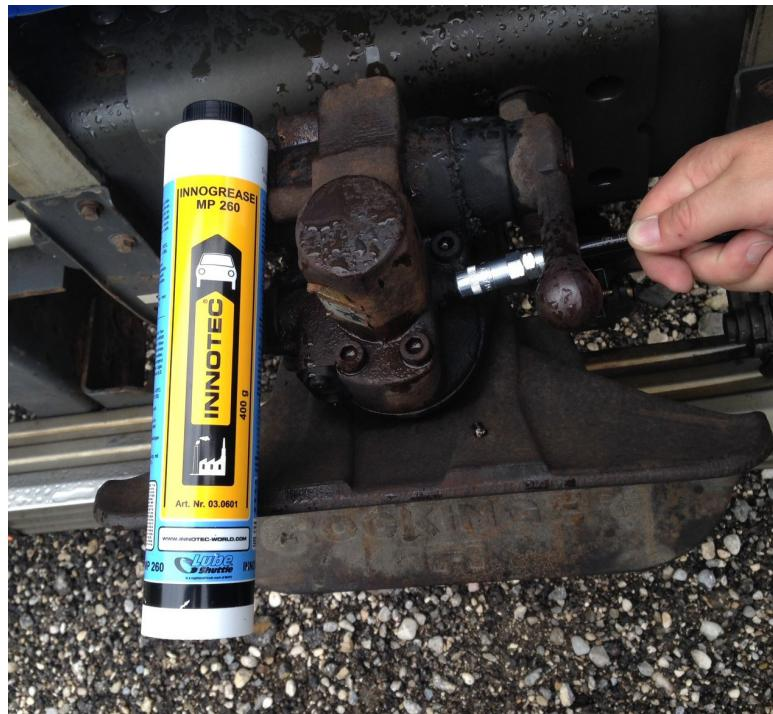
Innogrease MP 260 ist ein vielseitig einsetzbares Mehrzweck-Kartuschenfett mit schwermetallfreien EP-Additiven. Durch hohe Druckbeständigkeit, ausgezeichnetes Schmiervermögen – selbst unter Wasser – und sehr geringen Reibungswiderstand sorgt es für eine lange Lebensdauer geschmierter Teile, auch in nasser, schmutziger und staubiger Umgebung.
