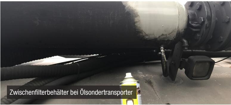
Zwischenfilterbehälter bei Ölsondertransporter
