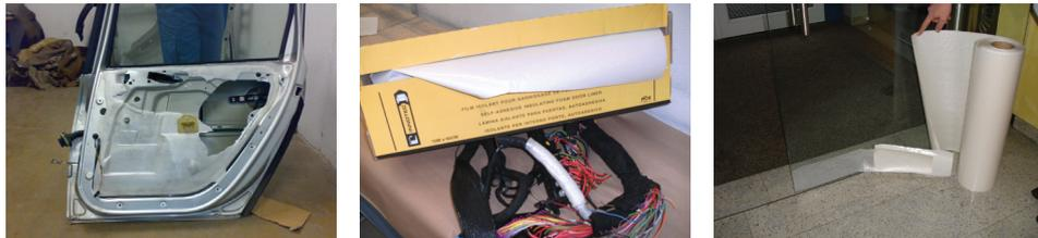
Door Finish ist eine einzigartige, selbstklebende Innentür-Verkleidung, die eigens zu dem Zweck entwickelt wurde, das Eindringen von Wasser und Schallwellen aus dem Innenhohlraum der Tür in das Fahrzeug zu unterbinden.
