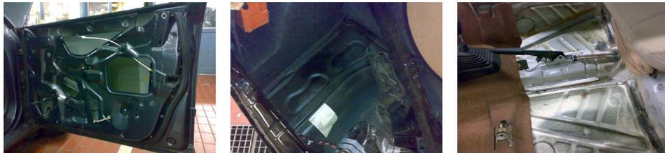
Anti Vibration Plates sind selbstklebende Dämmplatten zur Vermeidung störender oder sogar schädigender Resonanzen in einer großen Bandbreite von Anwendungen.
