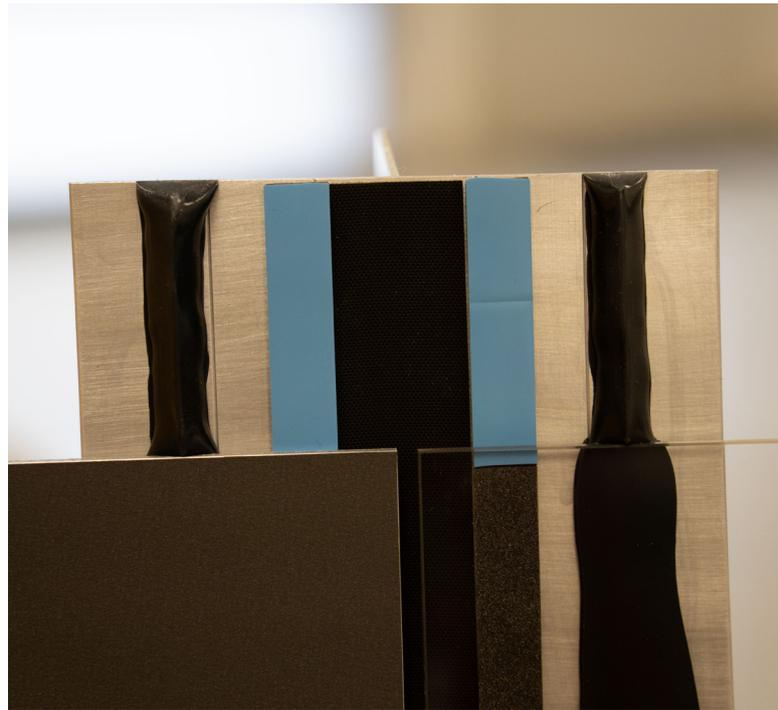
Fixation Tape Project 1 ist ein unterstützendes doppelseitiges Klebeband zur Fixierung von Fassadenplatten auf Alu-Unterkonstruktionen bis Adheseal Project ausreichend ausgehärtet ist und selbst die volle Klebekraft erreicht hat.
