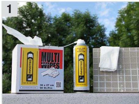
1 Untergrund mit Seal and Bond Remover (Klebstoff- & Dichtmassenentferner) und Multi Wipes (Universaltuch) reinigen/entfetten (ca. 5 Min. ablüften lassen).
