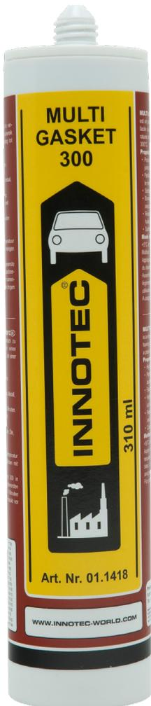
Multi Gasket 300 ist eine besonders hochwertige und einfach zu verarbeitende Gehäusedichtmasse, die einen Temperaturbereich von -60°C bis +260°C (Spitzenbelastung bis +300 °C) hat. Die Dichtmasse besteht aus synthetischem Kautschuk und ist als Ersatz oder Unterstützung diverser Standarddichtungen (z.B. bei Getrieben, Antriebswellen etc.) verwendbar.
