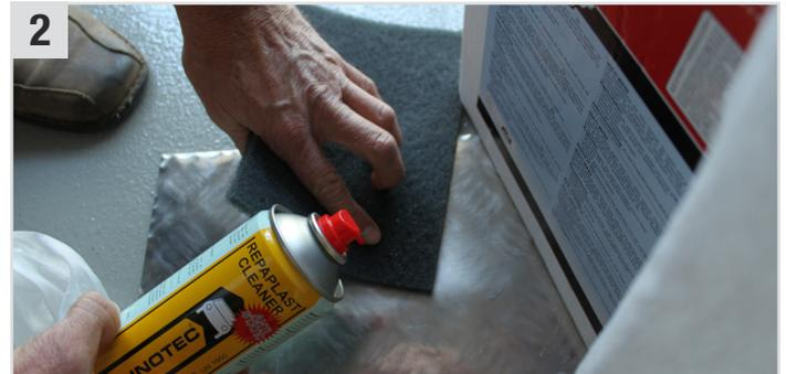
2 Alu-Untergrund (oxidiert) eventuell mit **Shine P 600** (Schleifvlies) aufrauen und nochmals mit **Repaplast Cleaner Antistatic** (Kunststoff-Reiniger) und **Multi Wipes** (Universaltuch) gut reinigen (ca. 5 Min. ablüften lassen).
