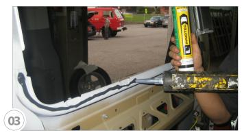
Adheseal (Streichbare Klebedichtmasse) mit geeignetem Werkzeug auftragen
