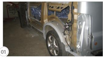
Blank geschliffene Stellen mit Construction Primer (Rostschutzgrundierung) grundieren
