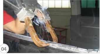
Seitenwand anbringen und fixieren und anschliessend mit der Schweisszange durchpunktieren
