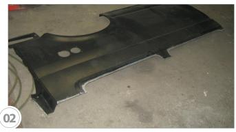
Originalgrundierung der Seitenwand nur aussen blank schleifen (Kontakt für Punktzange) und Innen mit Construction Primer (Rostschutzgrundierung) grundieren
