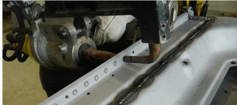
Zinc Coat ist eine besonders hervorragende Rostschutzbeschichtung auf Zinkbasis, welche sowohl vor, als auch nach dem Schweißen anwendbar ist. Zinc Coat bildet eine Schutzschicht die sich bestens zum Kohlendioxid (CO<sup>2</sup>)- und Punktschweißen eignet.
