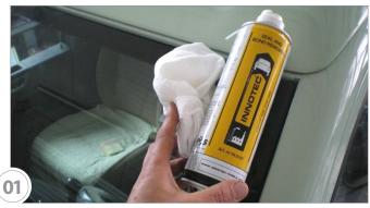
Mit Seal and Bond Remover (Klebstoff- & Dichtmassenentferner) und Multi Wipes Box (Universaltuch) gut reinigen und anschliessend 10 Minuten ablüften lassen
