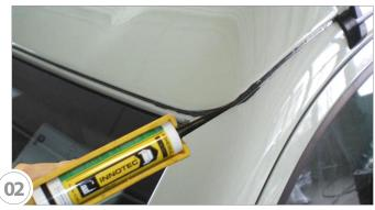
Adheseal (Streichbare Klebedichtmasse) mit geeignetem Werkzeug auf gereinigte Fuge auftragen
