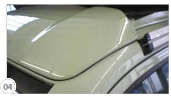
Eventuelle Dichtmassenrückstände mit Seal and Bond Remover (Klebstoff- & Dichtmassenentferner) entfernen
