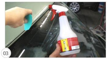
Überschüssiges Material mit Fugenspachtel entfernen und abglätten. Wichtig: Fugenspachtel-Set und Dichtmasse immer mit Seal Fluid (Glättmittel) besprühen!
