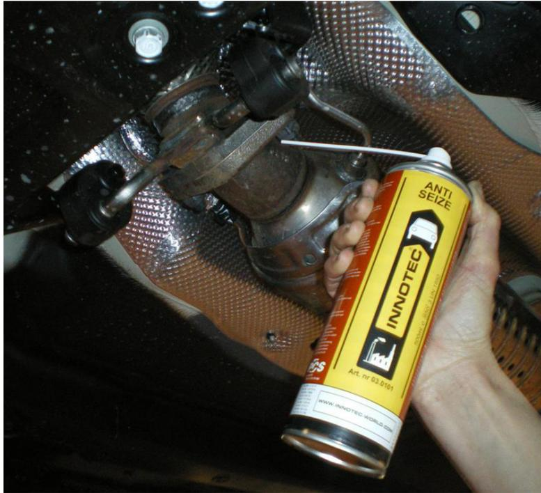
Der Markt verlangt häufig nach einem hitzebeständigen Fett, das dauerhaft schmiert und einfach anzubringen ist. Zudem ist es oft wichtig, dass diese Fette eine leichtere Montage und später eine problemlose Demontage ermöglichen.
