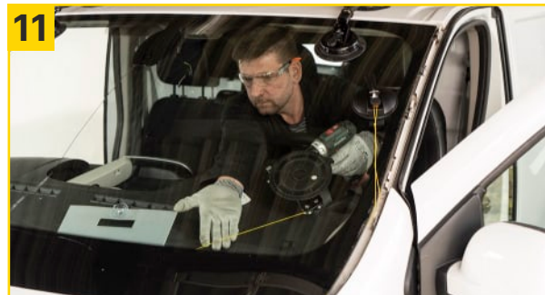
11 Austrennvorgang fortführen bis die linke untere Ecke erreicht ist und anschließend die Werkzeuge demonstrieren.
