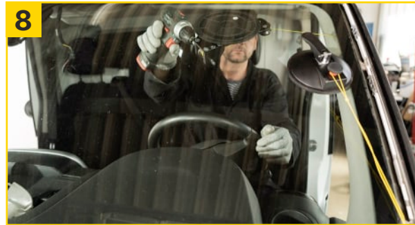
8 Akkuschauber auf Spule platzieren und langsam nach rechts laufen lassen (Drehzahl anpassen).
