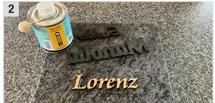
Seal Guard (Transparenter Primer) mithilfe des Wollwischers in einer dünnen Schicht auf die Schriftzüge auftragen und ca. 15 Min. ablüften lassen.
