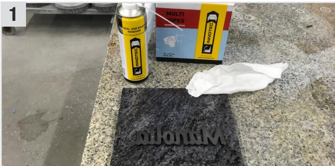
Die zu verklebenden Untergründe mit Seal and Bond Remover (Klebstoff- & Dichtmassenentferner) und Multi Wipes (Universaltuch) reinigen/entfetten und ca. 5-10 Min. ablüften lassen.
