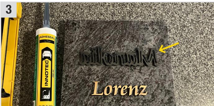
Adheseal (Streichbare Klebedichtmasse) vorsichtig auf die Schriftzüge auftragen (Auftragsmenge mind. 1 mm).
