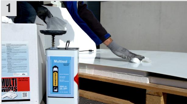
1 Die Rückseite des Photovoltaik-Moduls mit **Multisol** (Entfetter / Reiniger) und **Multi Wipes** (Universaltuch) gut reinigen und mit trockenem **Multi Wipes** nachwischen (ca. 10 Min. ablüften lassen). Die Vorderseite des Photovoltaik-Moduls darf hierbei nicht auf einem scharfen oder kantigen Untergrund liegen (um Beschädigungen des Moduls zu vermeiden).
