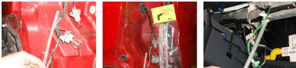
Easy Fit Sleeves sind Kunststoffhülsen, die speziell zur Isolation elektrischer Drahtverbindungen entwickelt wurden. Die Hülsen haben einen wärmeleitenden Kern, diese werden mit einem industriellen Föhn zusammengeschnitten. Hierdurch entsteht eine perfekt isolierte und wasserdichte Verbindung, die zugleich eine optimale Zugentlastung erhält.
