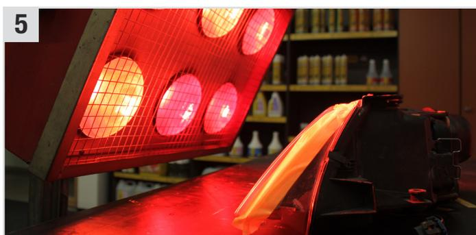
**5** Mit einem (Infrarot-)Trockner oder in einem Backrohr bei 90°C 90 Minuten oder bei 110°C 60 Minuten aushärten lassen!
