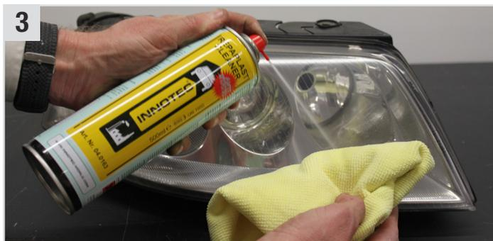
**3** Mit **Clean & Shine Towel** (Wabenstrukturtuch) und **Repaplast Cleaner Antistatic** (Kunststoff-Reiniger) Scheinwerferglas reinigen.
